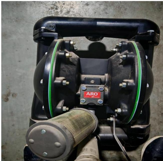
气动耐腐蚀隔膜泵
