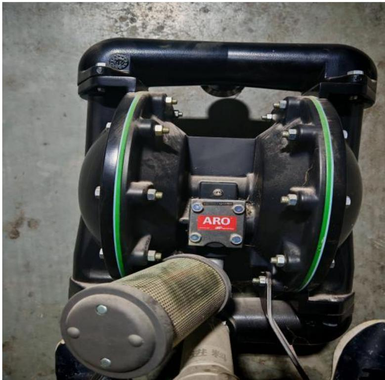
气动耐腐蚀隔膜泵
